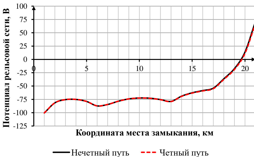
Рисунок Д.26 – Зависимость потенциала рельсовой сети обоих путей от координаты места замыкания в месте расположения тяговой подстанции «Сабик» для варианта конструктивного исполнения с использованием комбинированного заземлителя
