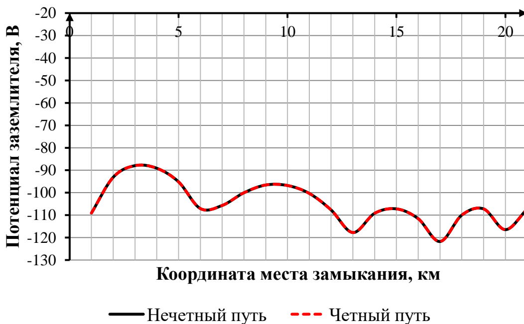
Рисунок Д.25 – Зависимость потенциала заземлителя обоих путей от координаты места замыкания в месте расположения пункта параллельного соединения «ППС 1707» для варианта конструктивного исполнения с использованием комбинированного заземлителя
