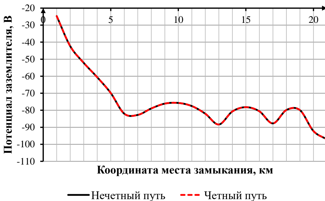
Рисунок Д.17 – Зависимость потенциала заземлителя обоих путей от координаты места замыкания в месте расположения пункта параллельного соединения «ППС 5,6» для варианта конструктивного исполнения с использованием комбинированного заземлителя
