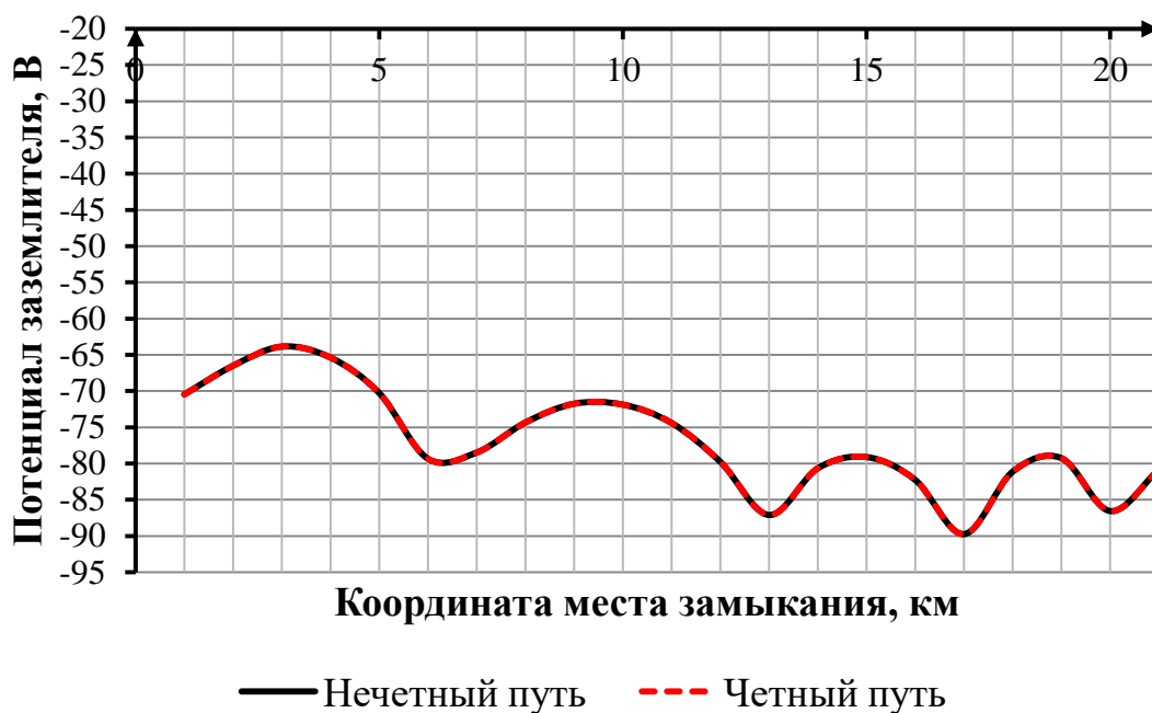
Рисунок Д.23 – Зависимость потенциала заземлителя обоих путей от координаты места замыкания в месте расположения пункта параллельного соединения «ППС 1704» для варианта конструктивного исполнения с использованием комбинированного заземлителя
