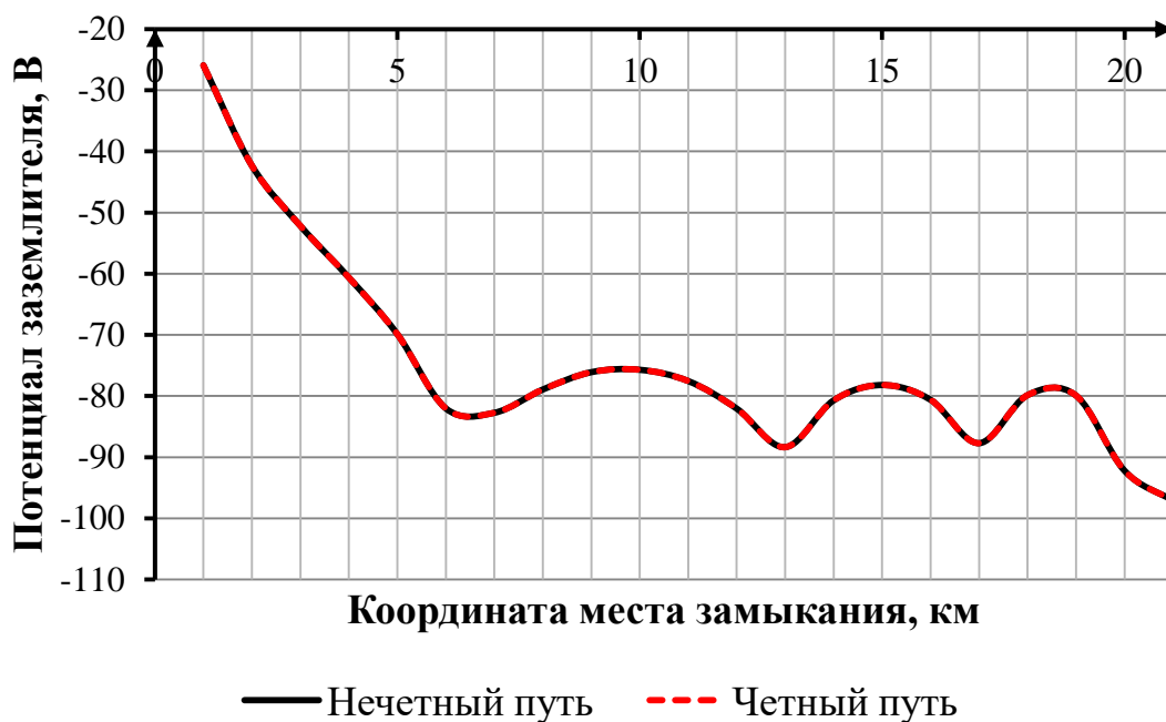
Рисунок Д.31 – Зависимость потенциала заземлителя обоих путей от координаты места замыкания в месте расположения пункта параллельного соединения «ППС 5,6» для варианта конструктивного исполнения с использованием заземляющего провода
