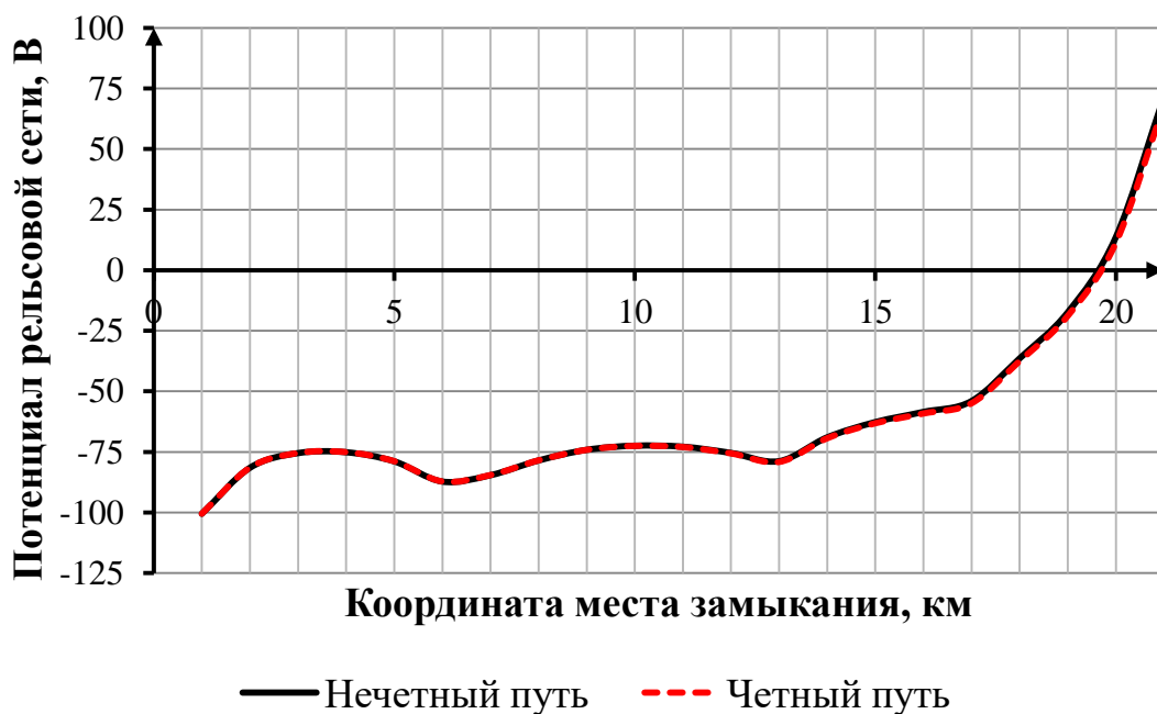
Рисунок Д.40 – Зависимость потенциала рельсовой сети обоих путей от координаты места замыкания в месте расположения тяговой подстанции «Сабик» для варианта конструктивного исполнения с использованием заземляющего провода
