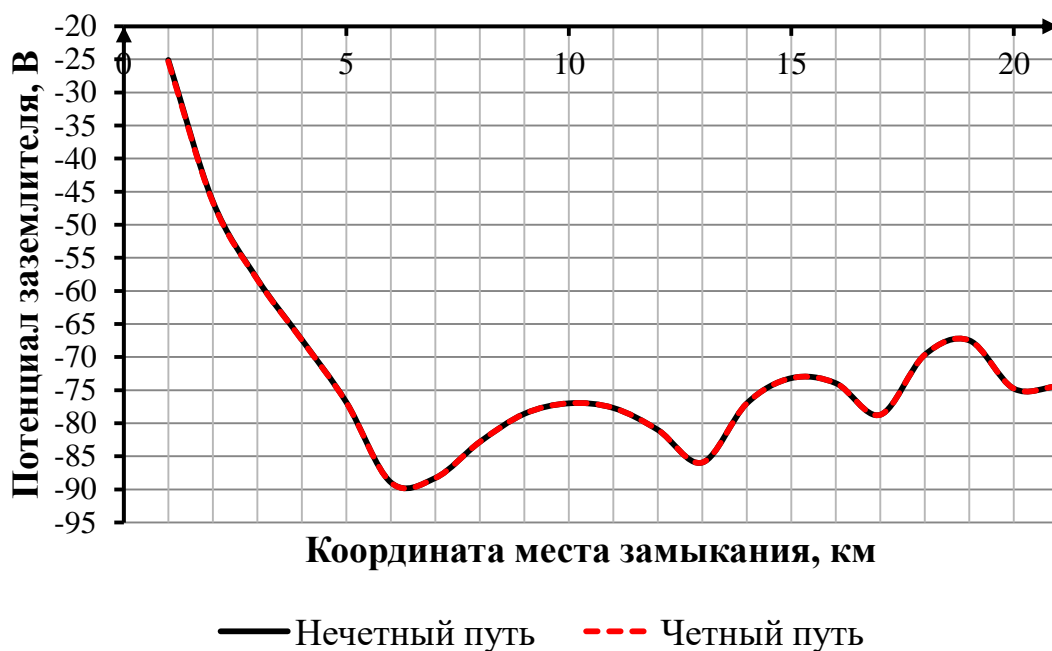
Рисунок Д.1 – Зависимость потенциала заземлителя обоих путей от координаты места замыкания в месте расположения тяговой подстанции «Сарга» для варианта конструктивного исполнения с горизонтальным заземляющим электродом
